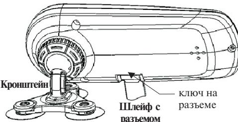
Для быстрого отключения компьютера необходимо отсоединить шлейф, рис. 2.8.
